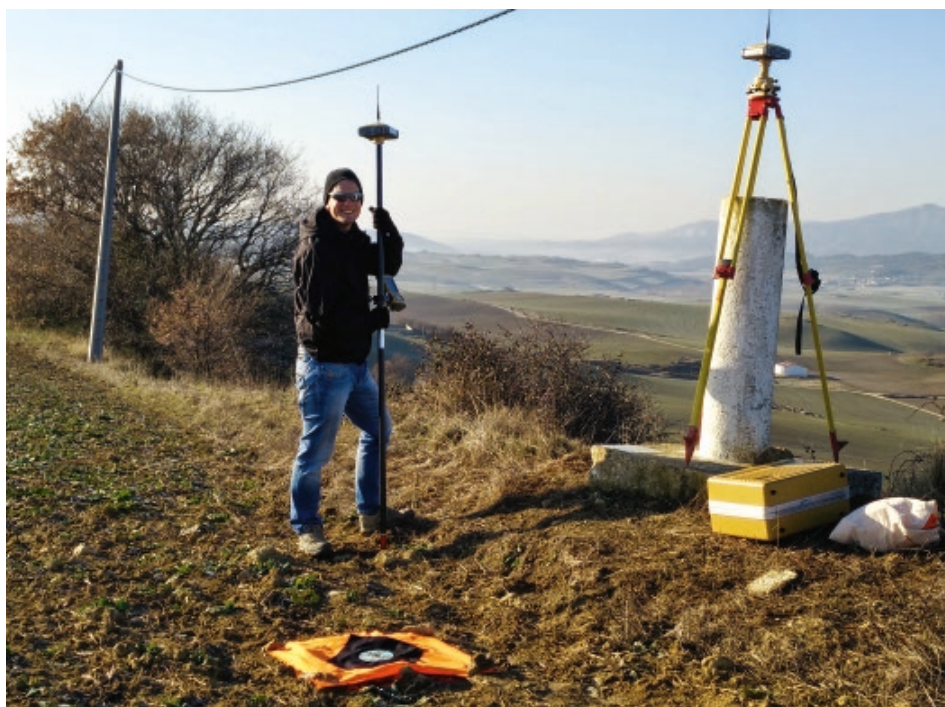
Inmeten van grond controlepunten voor de UAV(drone) data met behulp van RTK GPS.
