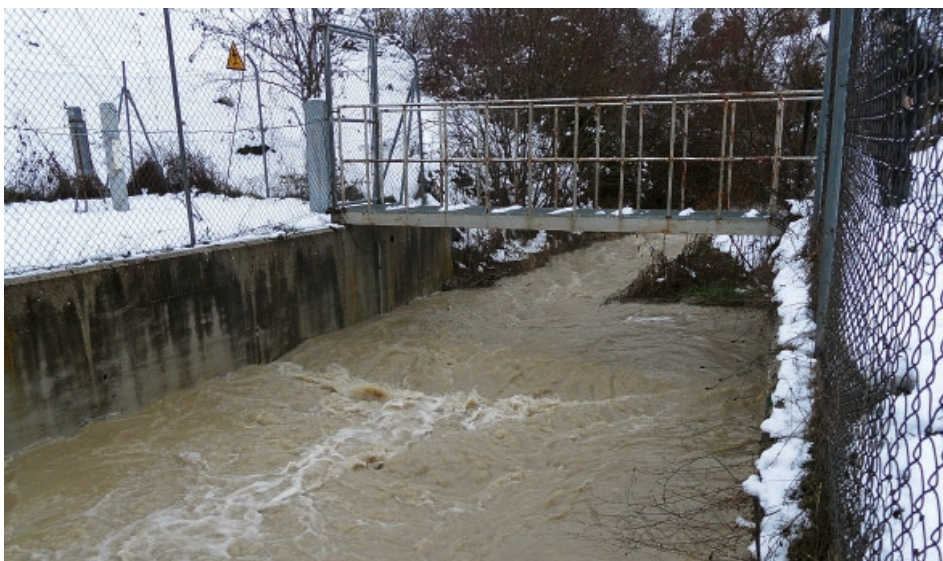
Hydrologisch station: Hydrologisch en meteorologisch station in een van de stroomgebieden. Hier worden debiet, sedimentconcentratie en meteorologische variabelen gemeten.
